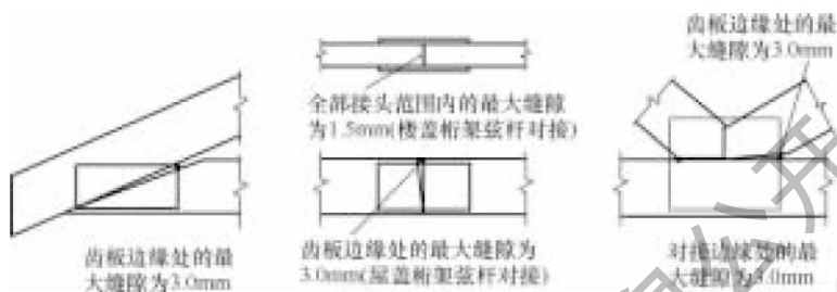
图 6.3.3-2 齿板桁架木构件间允许缝隙限值
